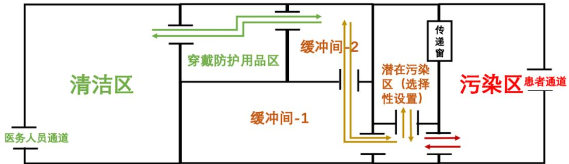
图1-1 同一通道进出流线布局流程示意图
