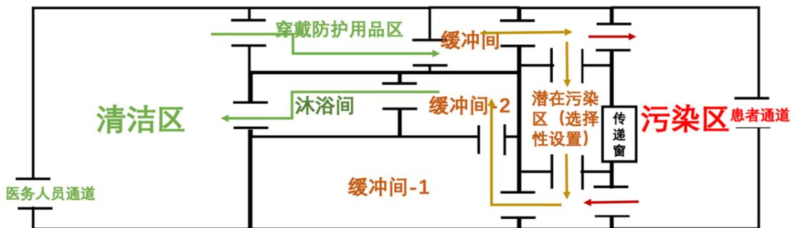
图1-2 不同通道进出流线布局流程示意图
