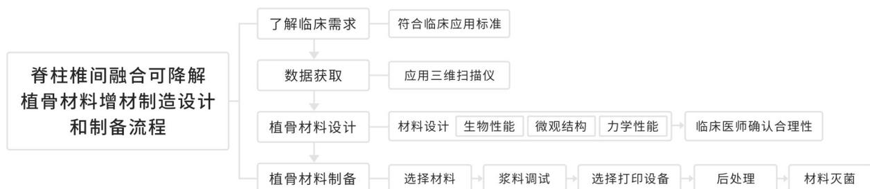
图1 脊柱椎间融合可降解植骨材料增材制造流程图
